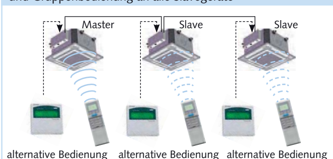
Ansteuerung im Netzwerk mit fünfstufigem Ventilatorbetrieb und Gruppenbedienung an alle Slavegeräte
