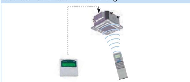
Ansteuerung im Netzwerk mit fünfstufigem Ventilatorbetrieb und Gruppenbedienung an alle Slavegeräte
