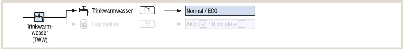
Der Regler ist mit einer Trinkwarmwasservorrangschaltung ausgestattet. Der Trinkwarmwasserfühler (THW5A [Speichermodul]/ THW5B [Speicher- und Hydromodul]), der im Trinkwarmwasserspeicher installiert ist, meldet dem Regler ständig die aktuelle Temperatur des Trinkwarmwassers. Ist die Hysterese TWW unterschritten, schaltet das System das 3-Wege-Umschaltventil und das Wasser wird erwärmt bis der Sollwert TWW erreicht ist.
