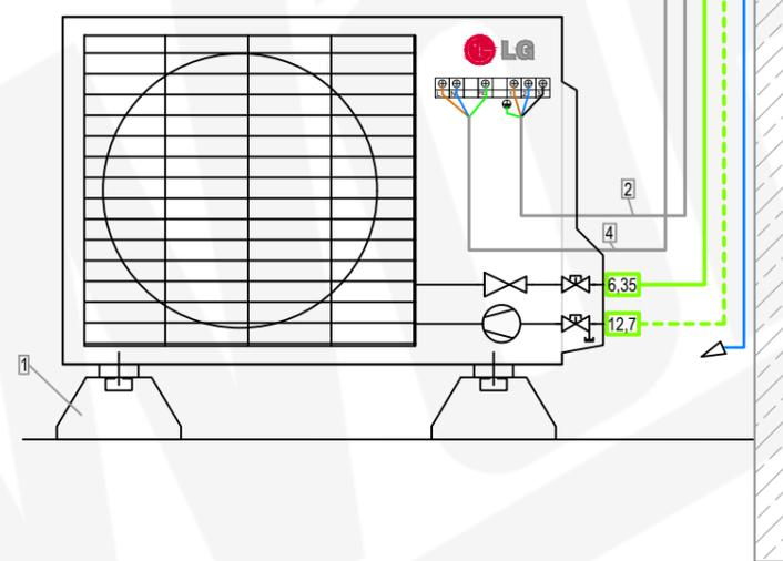
Kondensatablauf mit Kanalpumpe FL-K20K-SW rechts
