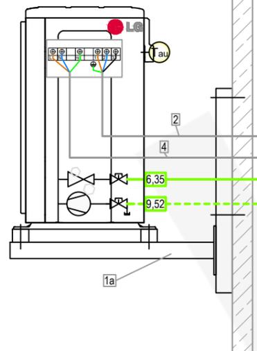
Aussengerät mit Dämpfungssockel
