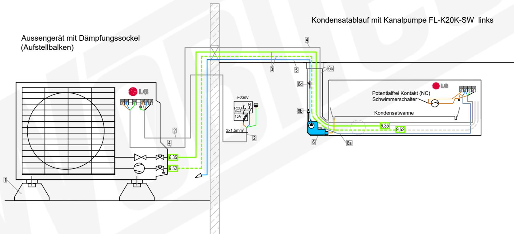
Kondensatablauf mit Kanalpumpe FL-K20K-SW links
