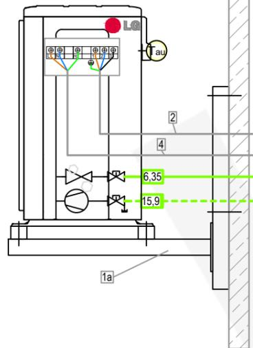
Aussengerät mit Dämpfungssockel
