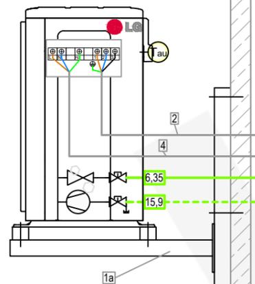
Aussengerät mit Dämpfungssockel
