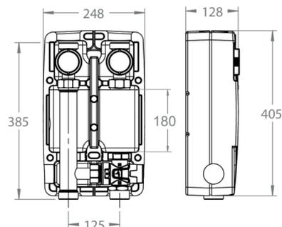
Stufenlos geregelt mit thermischen Mischventil
