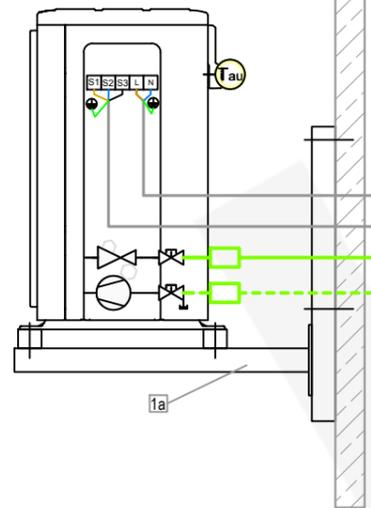
Aussengerät mit Dämpfungssockel
