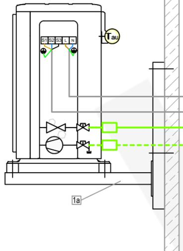
Aussengerät mit Dämpfungssockel
