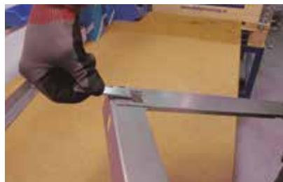
**3. Klopfen Sie die Bügel mit einem Hammer oder ähnlichem Werkzeug flach.**
