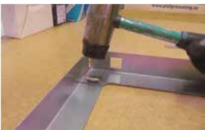
4. Montieren Sie nun die Seiten, indem Sie einen Verriegelungsbügel in die rechtwinklige Öffnung an den Ecken der Endstücke einführen. **ACHTUNG!** Sorgen Sie dafür, dass diese richtig eingeführt werden und wenden Sie für den nächsten Schritt genügend Druck an.
