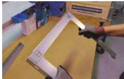
**2. Verwenden Sie den Montageschlüssel zum Drehen der Verriegelungsbügel. Sorgen Sie dafür, dass die Bügel mit den Löchern bündig sind, bevor Sie diese drehen. Gehen Sie bei diesem Vorgang vorsichtig vor.**
