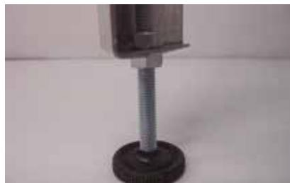
10. Setzen Sie die Vibrationsdämpfer auf die Querstangen, bevor Sie diese am Bodengestell montieren. Richten Sie die Maschine aus und ziehen Sie dann alle Muttern nach. **FERTIG!**
