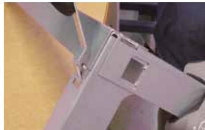
6. Drehen Sie zuerst den Verriegelungsbolzen an der langen Seite und dann an am unteren Teil. Wiederholen Sie diesen Schritt auf beiden Seiten.
