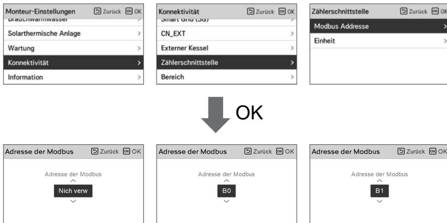
Es gibt 2 Optionen in dieser Funktion, Modbus-Adresse und Gerät. Wenn Sie die Modbus-Adresse-Option aktivieren, wählen Sie eine Adresse (B0 oder B1) oder nicht nutzen. Dann stellen Sie den Port und die Spezifikation in den Bereich von 0000.0~9999.9 [Impuls/kWh], wie in der nachstehenden Abbildung, ein.
